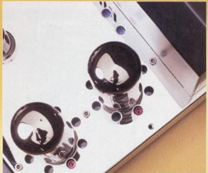
Arbeits-Punkte: Je zwei Justage-Potis schauen hinten aus dem Chassis raus, die Messkontakte finden sich direkt bei den Endröhren.
